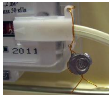
Рис. 4 - Место пломбирования датчика импульсов.
