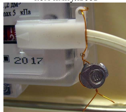
Рисунок 2 - Общий вид счетчика с датчиком импульсов
