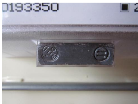
Рисунок 3 - Место пломбирования сумматора счетчика
