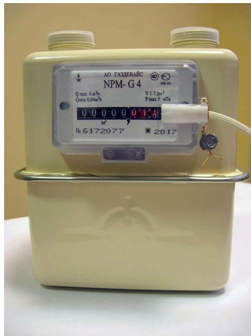
Рисунок 2 - Общий вид счетчика с датчиком импульсов
