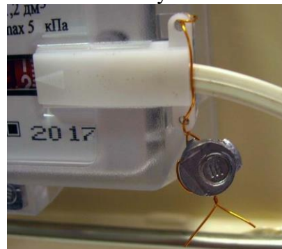
Рисунок 2 - Общий вид счетчика с датчиком импульсов
