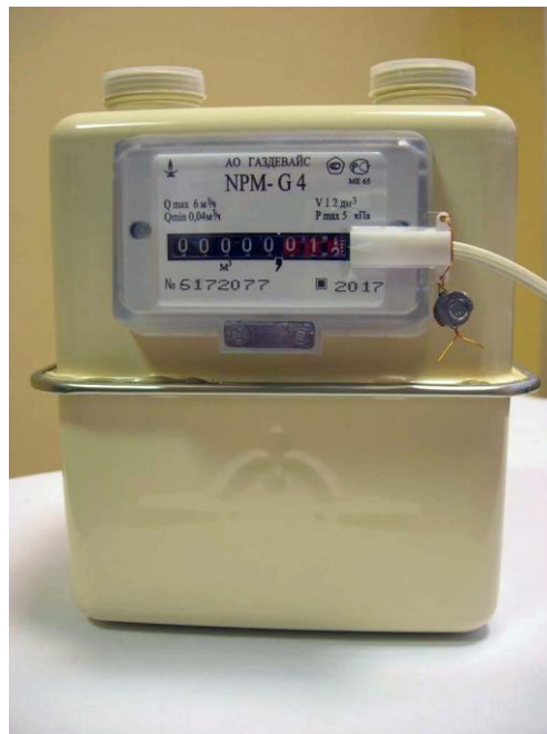
Рисунок 2 - Общий вид счетчика с датчиком импульсов
